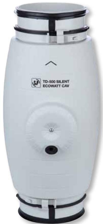
Ventiladores helicocentrífugos de bajo perfil, extremadamente silenciosos, fabricados en material plástico, con elementos acústicos (estructura interna perforada que direcciona las ondas sonoras, y aislamiento interior fonoabsorbente que amortigua el ruido radiado), cuerpo-motor desmontable sin necesidad de tocar los conductos, juntas de goma en impulsión y descarga para reforzar la estanqueidad.
